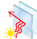
Vidrio aislante 366 de baja emisividad de dos hojas con argón
