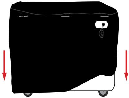
Retire los pesos y colocar el cable de alimentación a través de la apertura y dejar que el panel posterior caída en su posición.
