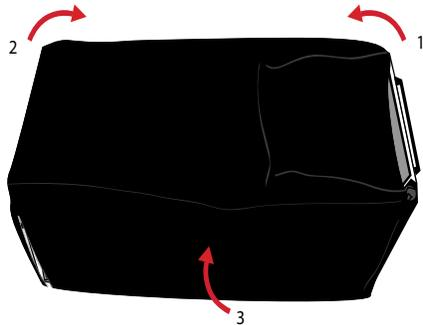
Para acceder tanto a los cajones frontales y laterales, descomprimir las cuatro cremalleras. Primero coloque los paneles laterales en la parte superior de la caja de herramientas y, a continuación colocar el panel frontal en la parte superior de la caja de herramientas.
