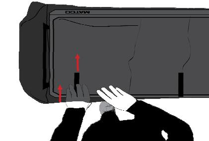
Si las 1"x 8" correas de velcro están expuestas, levante primero la parte superior de la tapa ligeramente y deslizar los tirantes debajo de la cubierta.
