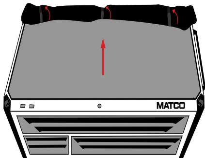
Para acceder a la superficie superior, tirar los paneles hacia la parte trasera de la caja de herramientas y fije las correas de velcro para asegurar.
