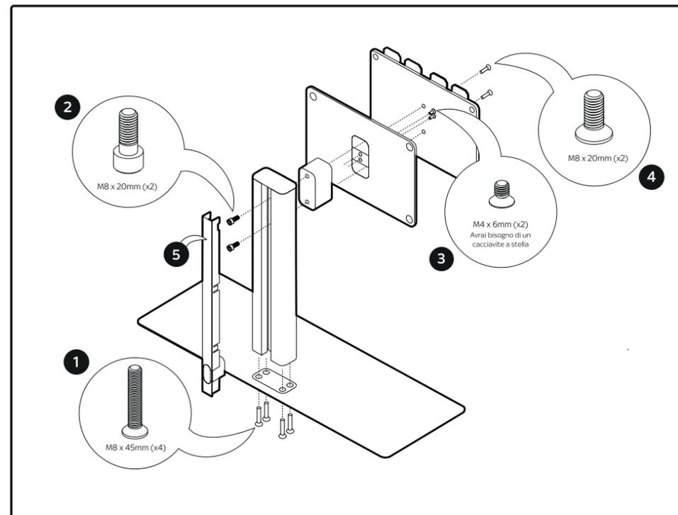
Prima di iniziare bisogna disporre di un cacciavite a stella e della chiave a brugola fornita in dotazione.
