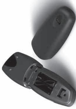
Il telecomando del Decoder funziona con due batterie di tipo AA a 1,5 Volts.
