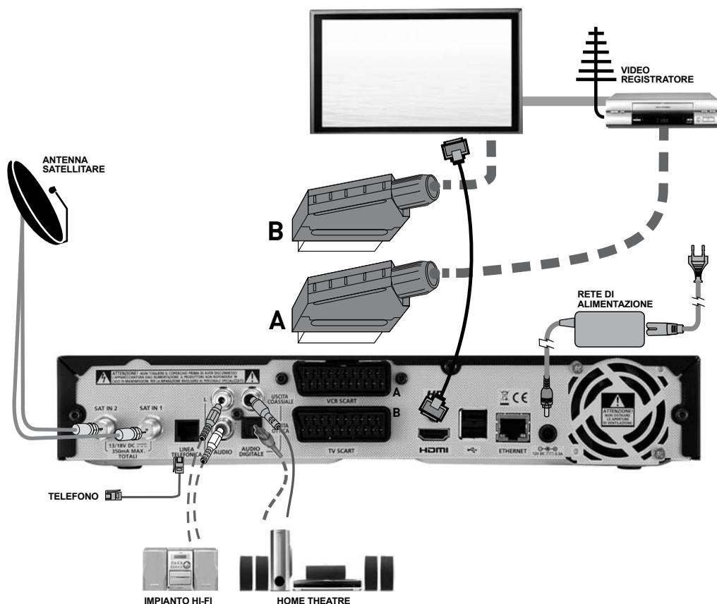
Il collegamento del Decoder Digitale MySKY HD ad un televisore "HD Ready" andrà effettuato tramite l'uscita HDMI™.
