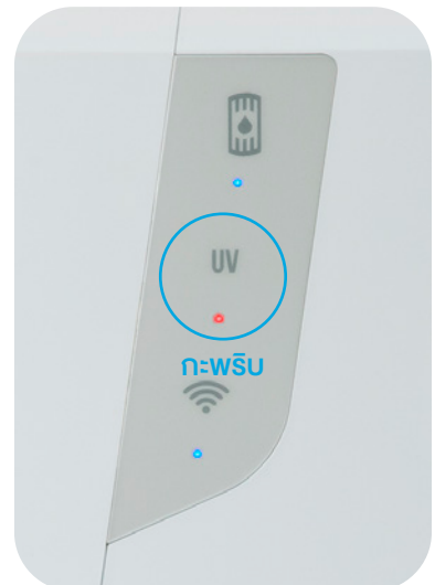
ส่งเสียงบีบอย่างรวดเร็ระหว่างน้ำไหล = UV มีข้อผิดพลาด
