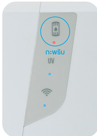
ส่งเสียงบีบอย่างรวดเร็ระหว่างน้ำไหล = RFID มีข้อผิดพลาด
