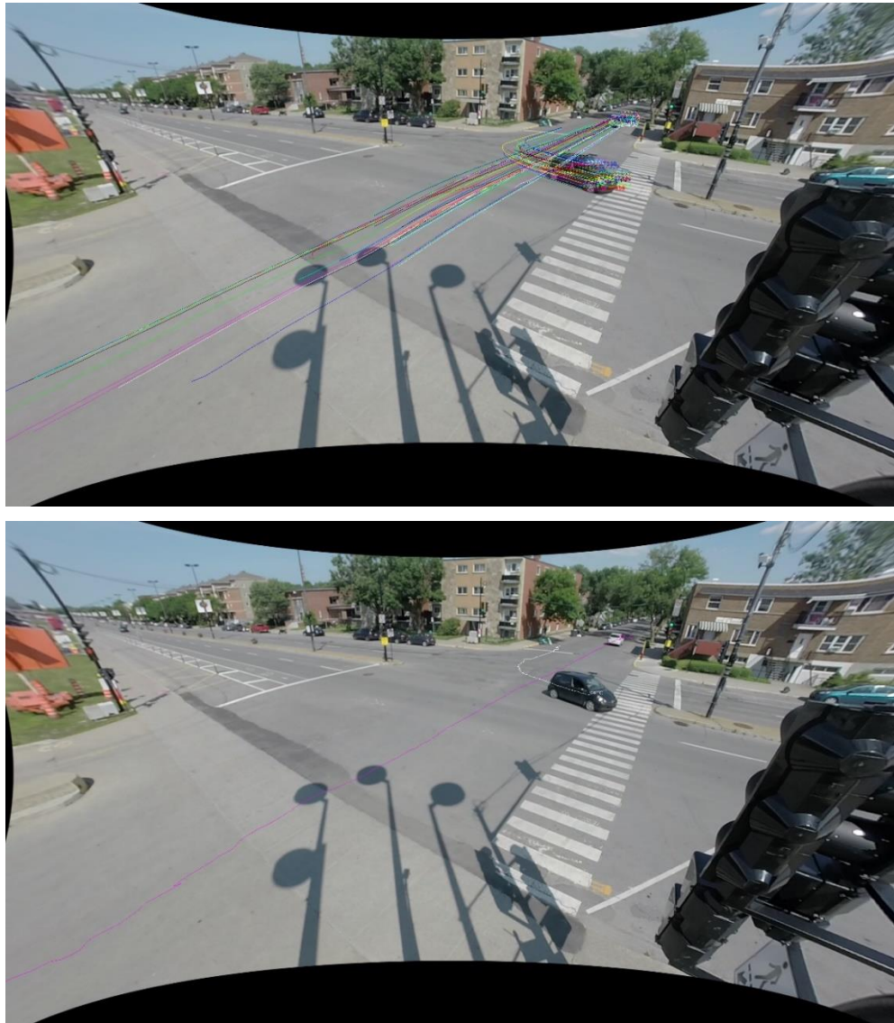
Figure A-2 : Exemple de détection et de suivi (trajectoire des points caractéristiques sur des usagers (au-dessus) et de leur regroupement par usager (en-dessous))
