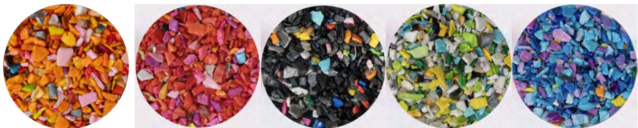
Die zerkleinerten Plastikteile werden gründlich gewaschen, um Unreinheiten wie Klebereste von Etiketten, Sandkörner und Staub zu entfernen.
