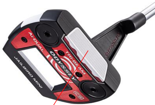
柔らかめの樹脂（白い部分）と硬めの樹脂（赤い部分） できているAi-DUAL・インサート。2つの層の境目は、AIの 設計により複雑な形状となっている
