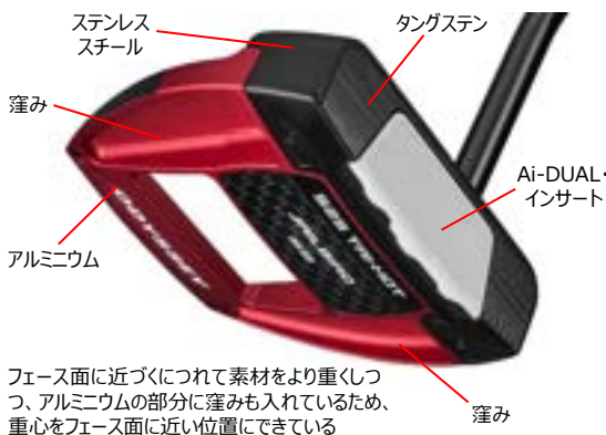
Ai-DUALインサートの分解図（イメージ）
