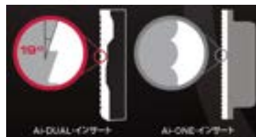
Ai-DUALインサートの断面図。溝が波型のAi-ONEインサートとは異なり、Ai-DUALインサートでは、二等辺三角形型となっている
