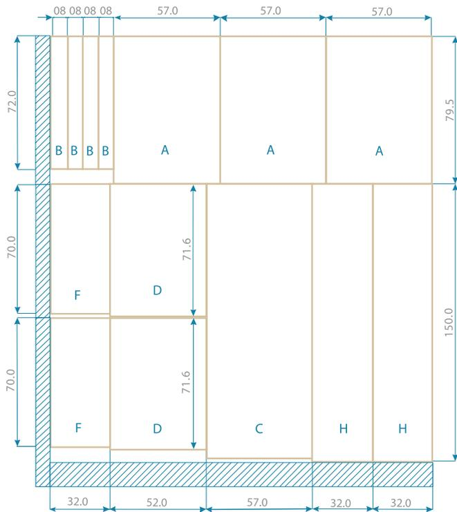
Se recomienda realizar primero en ambos tableros los cortes horizontales indicados para facilitar la modulación del mismo.
