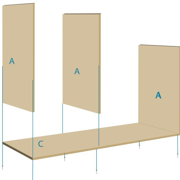
Le recomendamos colocar un trozo de alfombra o cartón en el piso para evitar que se dañe el tablero al amar el mueble. Antes de realizar unión de tableros con tornillos de ensamble recomendamos hacer una perforación guía avellanada para el tornillo.
