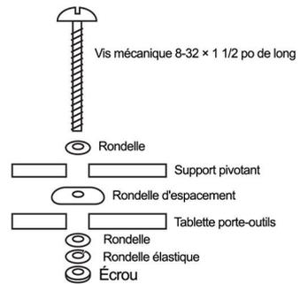
Figure 3 – Fixation du support pivotant
