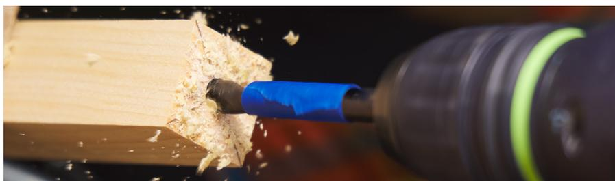
**Conseil :** Pour que les pièces soient d'équerre lors de l'assemblage, assurez-vous de percer droit. Pour ce faire, positionnez la perceuse de manière à ce qu'elle soit bien en ligne avec le poteau. À moins que la perceuse comporte un niveau intégré, il est plus difficile de maintenir l'alignement vertical que l'alignement latéral.
