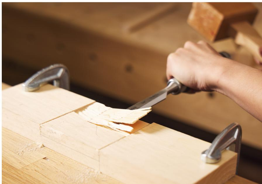
**Conseil :** L'évidage se fait à contrefil jusqu'au milieu de la pièce. Si vous évidez l'entaille sur toute la largeur de la pièce, vous risquez de provoquer des arrachements à la sortie. Il est normal que des fibres s'arrachent à l'avant du ciseau. Aussi, prêtez attention à l'orientation du fil du bois et, au besoin, faites des coupes obliques par rapport au fil du bois si celui-ci n'est pas parallèle à la pièce.
