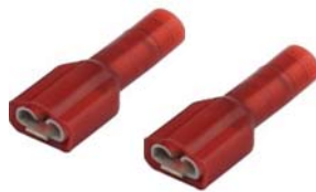
Figure 2 : Paire de connecteurs à sertir. Les deux connecteurs sont identiques. L'embout rectangulaire se raccorde par simple pression à une des bornes du micro-interrupteur. Le fil est inséré dans la partie tubulaire du connecteur afin de relier le micro-interrupteur au circuit. Une fois le fil inséré, utiliser des pinces à sertir pour fixer le connecteur au fil.
