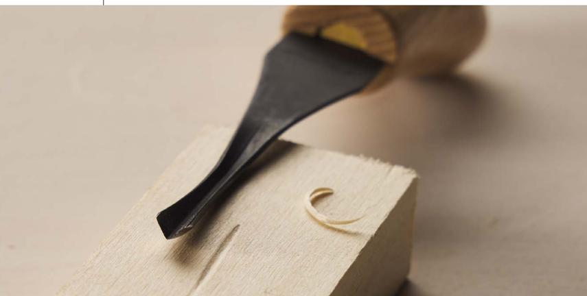
Le **burin à prise palmaire** comporte deux tranchants qui forment un V de 1/4 po, selon un angle de 70°. C'est l'outil tout désigné pour graver des lignes et des rainures en V. On l'utilise pour ajouter des détails, créer des textures ou encore pour tracer le contour d'éléments afin de délimiter leur forme et de leur donner de la profondeur.
